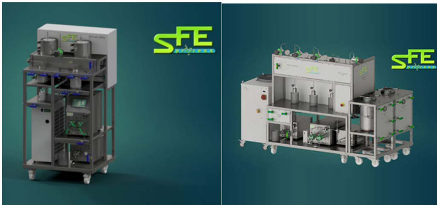
Rysunek 25. Ekstraktor nadkrytyczny CO 2 używany głównie w przemyśle, a Rysunek 26 ekstraktor nadkrytyczny CO 2 używany głównie w laboratorium [99].
