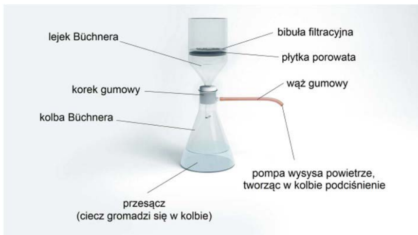
Rysunek 13. Zestaw do sączenia pod zmniejszonym ciśnieniem [69]
