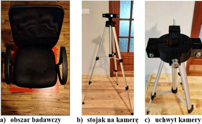
Rys. 2. Zdjęcia prezentujące obszar badawczy, stojak oraz uchwyt wykonany technologią druku 3D. Całość została wykorzystana w badaniach w celu ujednoczenia pomiarów, ustabilizowania i ustawienia pod odpowiednim kątem kamery termograficznej.
