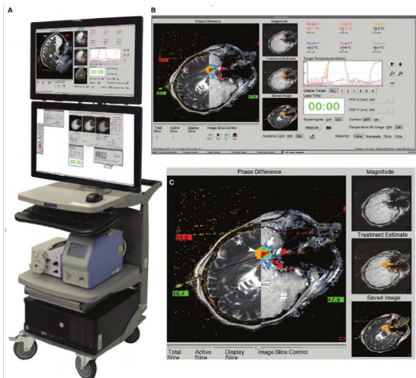
Ilustracja 2. - stacja pracy Visualase, (A) – komputer z dwoma monitorami, (B) – górny monitor w powiększeniu, (C) – górny monitor w powiększeniu z uwidocznioną płaszczyzną osiową [29]
